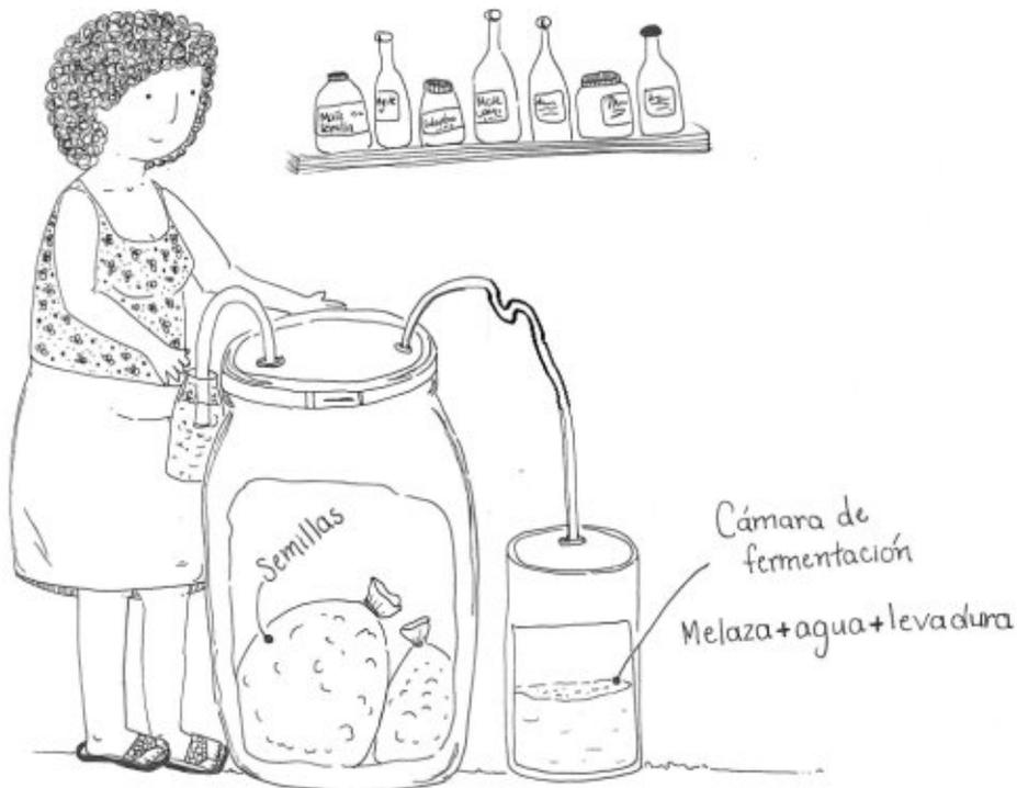
El principio de esta técnica es desplazar el oxígeno y sustituirlo con dióxido de carbono. El segundo tiene un mayor peso molecular que el oxígeno y por lo tanto lo saca del recipiente.
